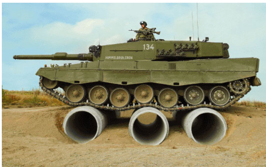
Betongrör tål tunga laster – utan kringfyllning. Bild: Basal, Norge
